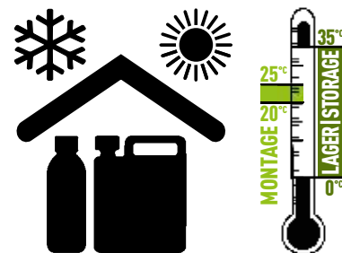
Abb. 7: Lagerung und Verarbeitung Muffenschaum
